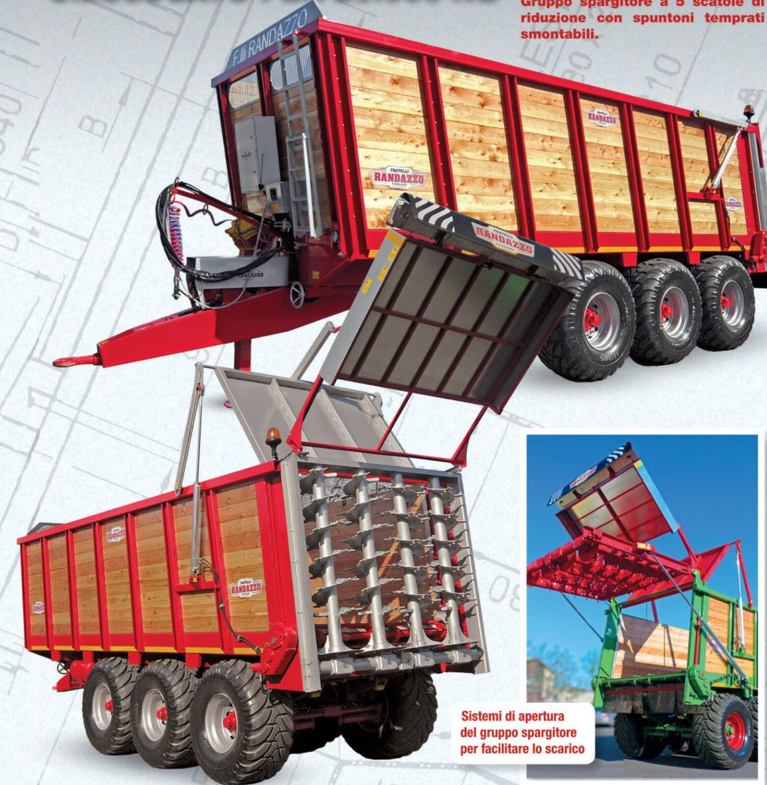
Sistemi di apertura del gruppo spargitore per facilitare lo scarico
