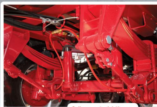
Sollevamento del 1° asse mediante n. 2 cilindri d.e
